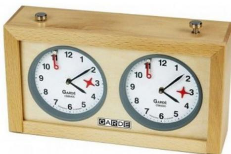
Comme leur nom l'indique, elles fonctionnent sans piles. Il faut donc les remonter avant de les utiliser. Leur fonctionnement se manifeste par un discret tic-tac mécanique. Le temps total alloué à chaque joueur au début de la partie est réglé, plus ou moins précisément, par la position des aiguilles. Quelques minutes avant la fin du temps alloué, la grande aiguille soulève un petit drapeau (rouge le plus souvent). Le dépassement du temps est indiqué par la chute du drapeau.
